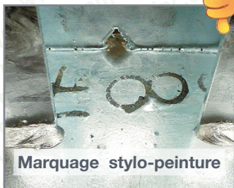
Photos 52 et 53 : Le repérage au marqueur et au feutre indélébile
