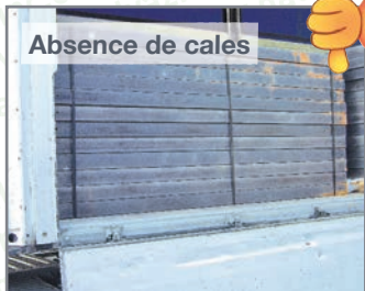
Photos 62 et 63 : Mauvais colisages
