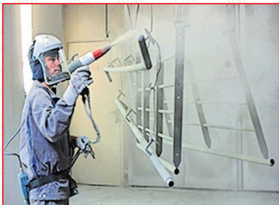
Photo 72 : Opération de thermolaquage sur pièces galvanisées à chaud
