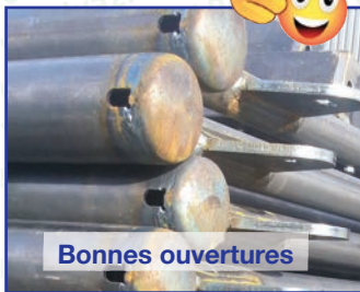
Photos 34 : Perçages en extrémité de tube fermé
