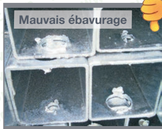
Photos 60 et 61 : Défauts d'ébavurage et de coulure
