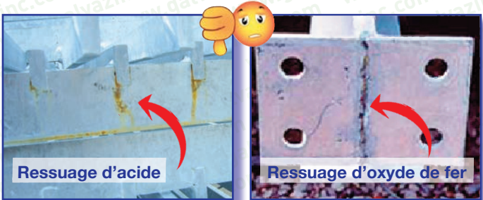
Photos 35 et 36 : Conséquences d'intervalles étroits
