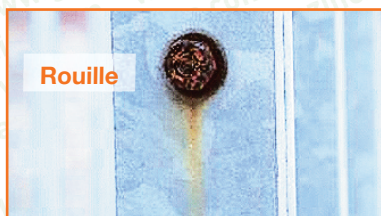
Photo 46 : Boulon électrozingué sur pièce galvanisée, en extérieur
