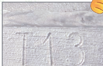
Photos 56 et 57 : La frappe à froid
