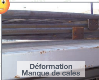
Photos 64 et 65 : Les conséquences d'un mauvais colisage
