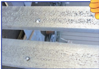
Photos 8 et 9 : Défauts dus au laminage
