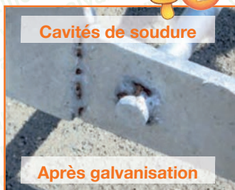
Photos 48 et 49 : Les défauts de soudures discontinues
